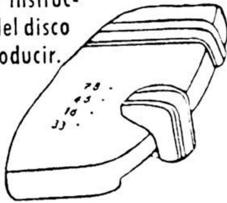
Colocar el disco (para los de agujero central grande, poner el adaptador "Z"), después situar la célula en posición M (discos microsurco) o N (discos normales). (ver figura 4)
